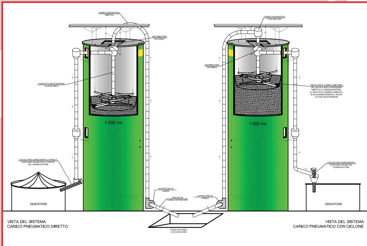
Ogni Silos dosatore può contenere **1000 Ton. di biomasse.**
